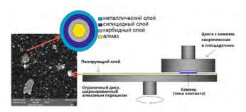
Рис.1. Схема механической обработки синтетических алмазов
